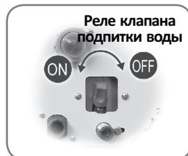
**⚠️ Внимание!** Давление воды в газовом котле не может превышать 1,2 бар. Помните, что клапан подпитки воды необходимо закрыть после подпитки воды, в противном случае будет включен предохранительный клапан сброса давления для сброса чрезмерно высокого давления в системе отопления. Чтобы избежать повреждения имущества, подсоедините водопроводную трубу от выхода предохранительного клапана к напольному трапу.
